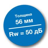
Данная конструкция имеет минимальную толщину 56 мм. При совсем незначительной толщине конструкция обеспечивает хороший прирост звукоизоляции на средних частотах.
