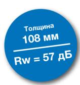
Ограждающая конструкция ПР-108 обеспечивают индекс звукоизоляции 57 дБ, что позволяет применять ее в многих областях строительства.
